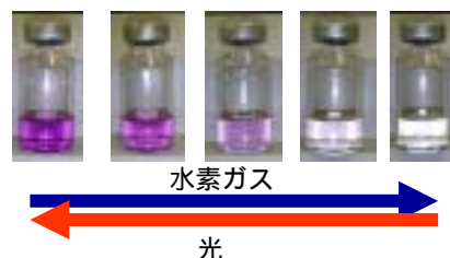
図2 ロジウム錯体の水素吸着と光による水素放出での色変化
