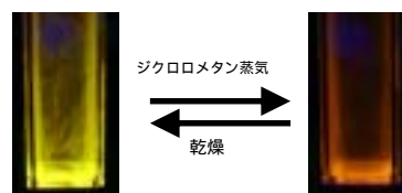
図1 ジクロロメタン蒸気下での白金錯体の発光色変化
